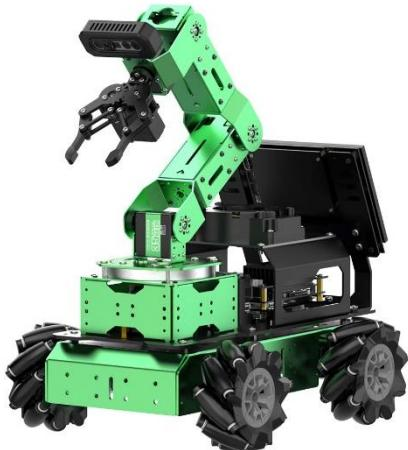
El JetArm Pro es un brazo robótico inteligente de alto rendimiento, diseñado para entornos de aprendizaje avanzado, investigación en inteligencia artificial y desarrollo de aplicaciones robóticas. Potenciado por las plataformas NVIDIA Jetson Nano, Orin Nano o Orin NX, ofrece un ecosistema completo para proyectos con ROS1 y ROS2, integrando visión 3D, aprendizaje profundo y control de precisión.
